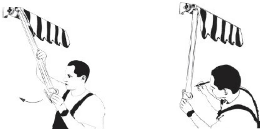
20) Lösen Sie die Fallarme aus dem Fallprofil und bohren die Löcher an den markierten Stellen vor.
