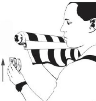
10) Mit Hilfe der Wasserwaage, richten Sie die Markise waagrecht aus.
