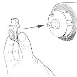
9) Auf den runden Bolzen mit dem Lager, setzen Sie den zweiten Wand-Deckenhalter.
