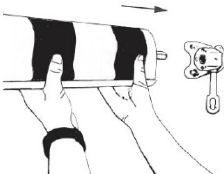
16) Setzen Sie die Markise mit dem runden Bolzen und dem Kunststofflager in den zweiten Halter und arretieren das Lager mit der Inbusschraube.
