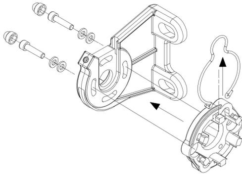
c) Den zusammengebauten Halter in an den Anker befestigen.
