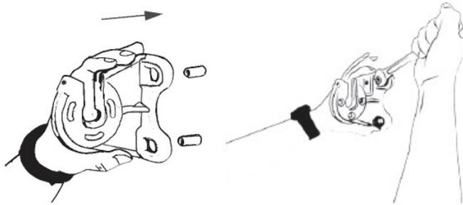
15) Setzen Sie die Markise mit dem quadratischen Bolzen in der Wickelrohrendkappe in den Halter auf der Antriebsseite.
