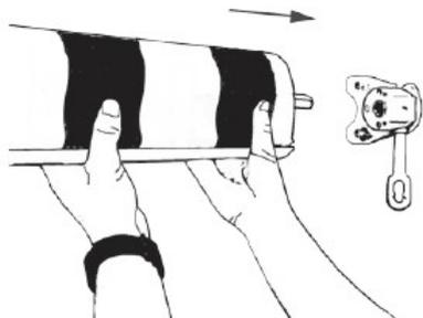
8) Auf der Seite mit dem runden Bolzen, setzen Sie das Kunststofflager.
