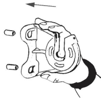
7) Setzen Sie die Markise mit dem quadratischen Bolzen (in der Wickelrohrendkappe) in den Halter auf der Antriebsseite.
